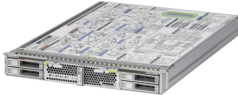
그림 1: 8코어/64스레드 또는 16코어/128스레드의 SPARC T3 프로세서를 장착한 SPARC T3-1B 서버 모듈
